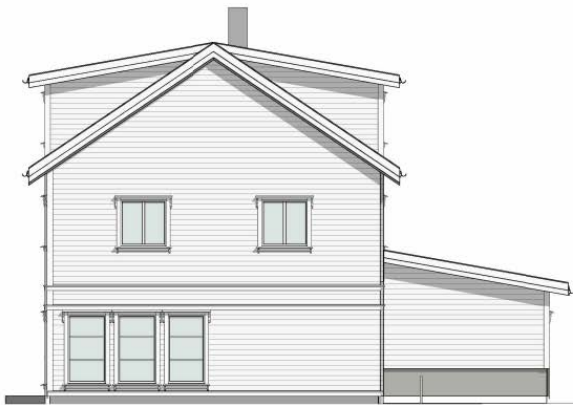
Fig. 6: Utkast fasade vest og sør viser planlagt tilbygg tilpasset eksisterende arkitektur fra 1960. Fasadene vender mot den SEFRAK registrerte og bevaringsverdige Doktorgården.
